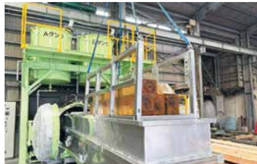
写真3 防腐処理の様子 奥の窯で薬剤を浸透させる
